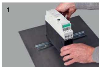
1 Nasadit frekvenční startér na montážní lištu.
