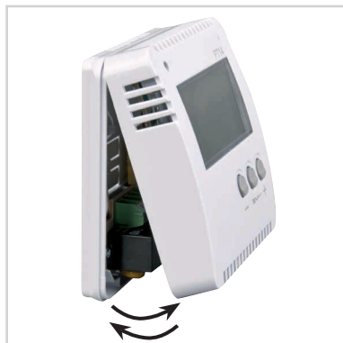
Obr. 4 Nasadte diel s elektronikou na spodnú časť a zaistite aretačnou skrutkou.
