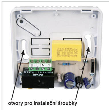
Obr.4 Nasadte díl s elektronikou na spodní část a zajištěte aretačním šroubem.
