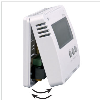
Obr.4 Nasadte díl s elektronikou na spodní část a zajištěte aretačním šroubem.
